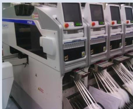
新引进的NXTIII贴片机，与传统西门子贴片机相比，极大提高了贴片产量，以下为两种设备贴片产量对比：
